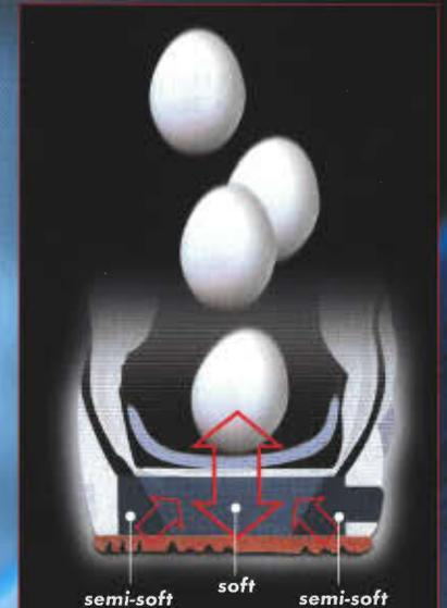
Die „Duale Power Cushion Konstruktion“ sorgt mit ihrer optimalen Einstellung in der Fersenmitte für Dämpfung und Energietransfer. Die härteren Seitenelemente bewirken eine effektivere Seitenstabilität.
